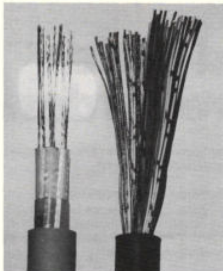
Afb. 3. De toegepaste kabels: zes basiselementen met ieder tien lichtaders vormen de kabel waarmee het experiment wordt uitgevoerd (links). Rechts op de foto de ouderwetse kabel met 60 koperaders.
